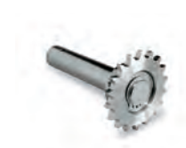
CRA1 As met rondsel met 18 tanden Ø as 25,4 mm Ø int. kroon 25,4 mm. Stuks/Verp. 1
